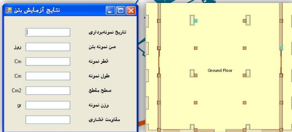
تصویر ۱۲: امکان لینک نتایج آزمایشات مختلف انجام شده در ساختمان به عارضه مربوطه بر روی نقشه
