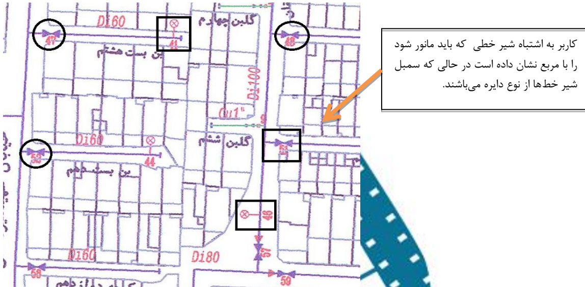
شکل ۳: نمونه ای از خطای مأمور بازدید و مانور در درج درست نوع علامت شیرآلات در شرکت های آب و فاضلاب
